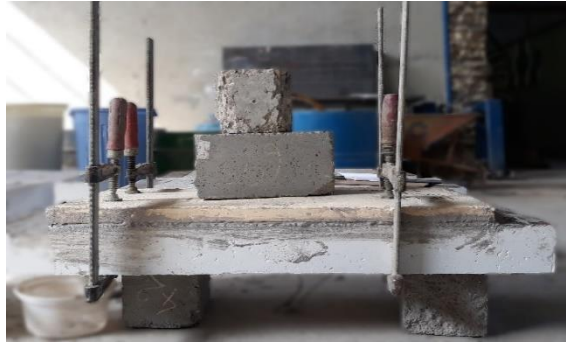
شکل ۱۵. گیرش بهتر با قرار دادن وزنه‌های سنگین
