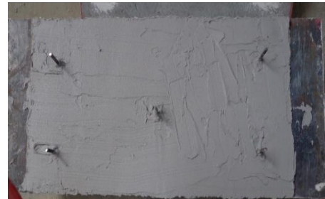
شکل ۱۴. نحوه اتصال ورق پیش ساخته حاوی میلگرد به دال‌ها Fig. 14. How to apply a laminate using bars on the slabs
