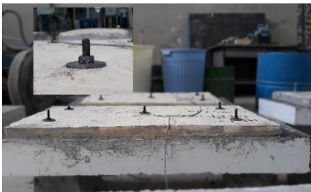
شکل ۱۴. نحوه اتصال ورق پیش ساخته حاوی میلگرد به دال‌ها Fig. 14. How to apply a laminate using bars on the slabs
