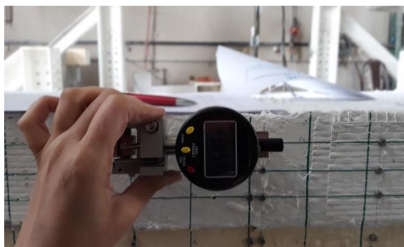
شکل ۲۱. نحوه استفاده از کرنش‌سنج‌های مکانیکی
