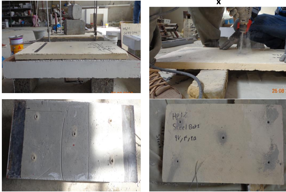
شکل ۱۱. گام‌های سوراخ‌کاری ورق‌های پیش ساخته حاوی میلگرد و دال‌های ضعیف Fig. 11. Drilling steps HPFRCC laminate using steel bars and weak slabs
