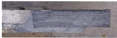
شکل ۱۷. مقاومسازی برشی دال‌ها Fig. 17. shear strengthening of slabs specimens
