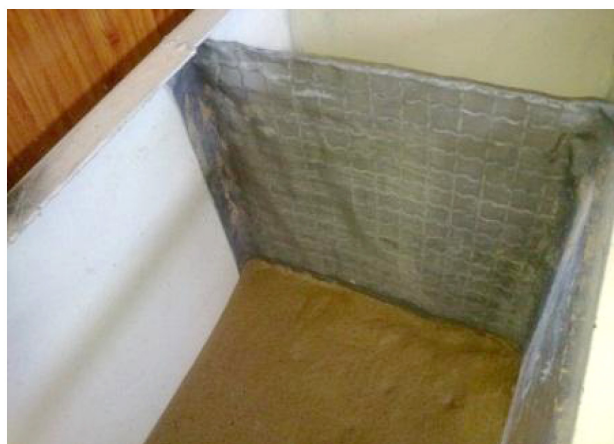
شکل (۱): نصب توری شماره ۱۵۰ برای جلوگیری از شسته شدن مصالح
