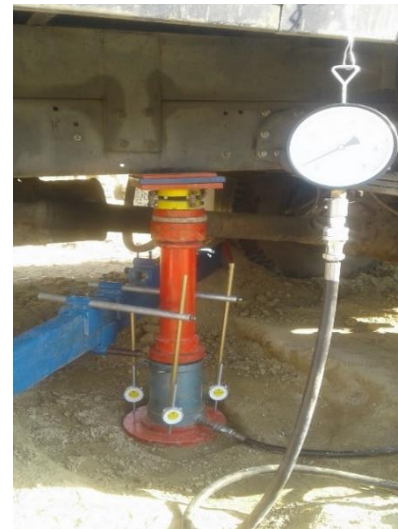
شکل ۲۹. نمایی از آزمایش بارگذاری صفحه‌ای انجام گرفته در محل سایت
