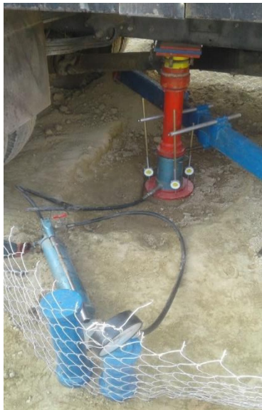
شکل ۳۰. نمایی از آزمایش بارگذاری صفحه‌ای انجام گرفته در محل سایت
