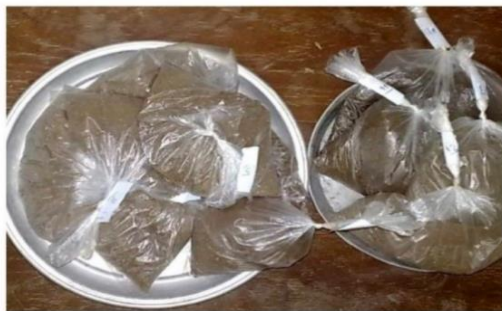
شکل ۳. نمونه‌های خاک ترکیب شده در کیسه‌های پلاستیکی در مدت عمل‌آوری
