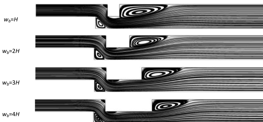
شکل ۹. خطوط جریان ( \phi=0.03, Re=100, h_b=H )
