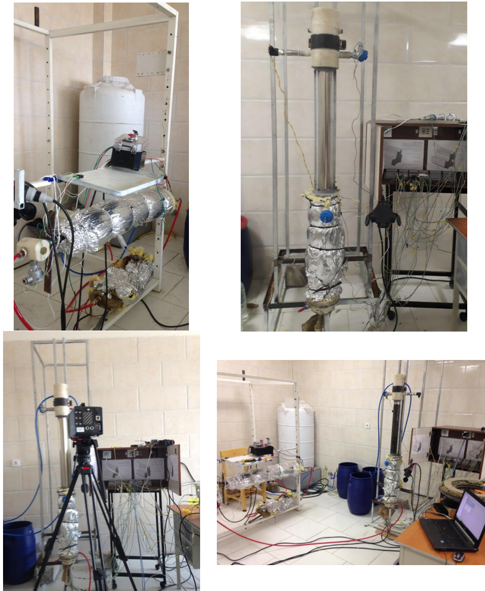
شکل ۱. ب) نمای کلی دستگاه آزمایش، تصویر بالا-چپ: مخازن ذخیره آب و پیش‌گرم، تصویر بالا راست: ست آب جریان جوشش، تصویر پایین-چپ: محل قرارگیری دوربین و داده‌بردار، تصویر پایین-راست: کل مجموعه آزمایش
