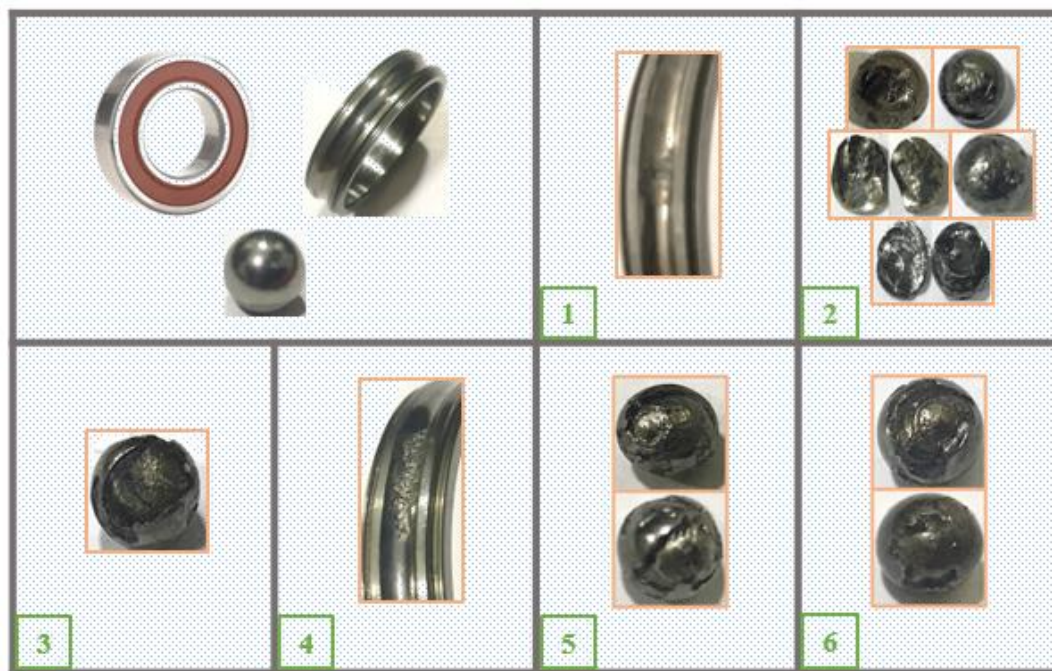
شکل ۳. خرابی مشاهده شده در هر کدام از یاتاقان‌ها پس از دمونتاژ آن در انتهای هر آزمایش
