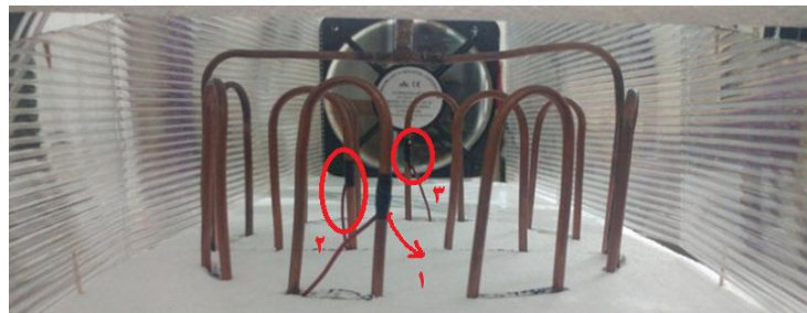
شکل ۳. کندانسور و محل نصب سنسورهای ترموکوپل بر روی آن
