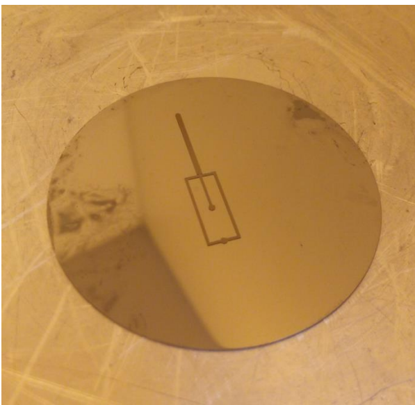
شکل ۳. قالب ساخته شده میکروکانال جریان متمرکزشونده بر روی ویفر سیلیکونی Fig. 3 Mold of flow focusing microchannel on silicon wafer
