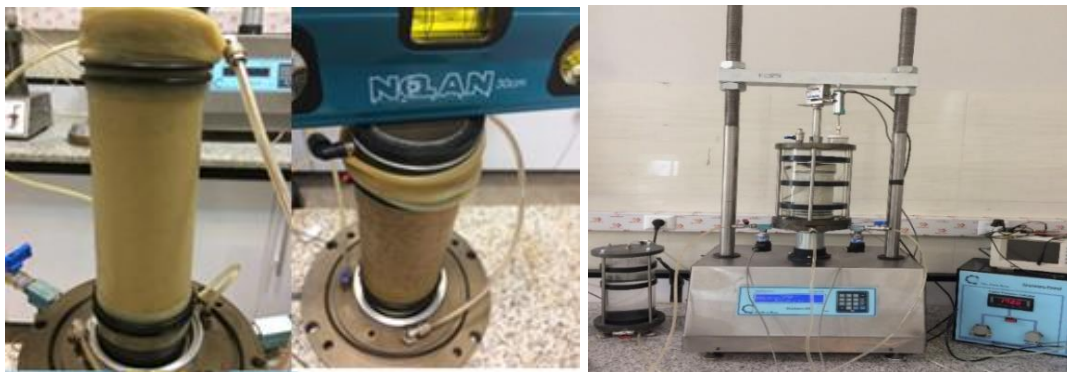
شکل ۳. تصویری از دستگاه سه محوری استاتیکی و نمونه سازی انجام شده در آزمایش
