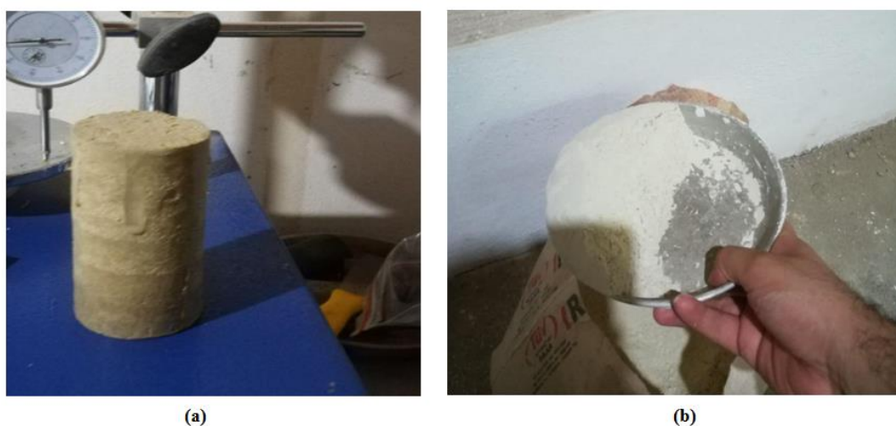
شکل ۴. (a) نمونه ساخته شده به روش تراکم مرطوب؛ (b) نمونه خاک رس مورد استفاده در تحقیق Fig. 4. a) Sample made by wet compaction method, b) clay samples used in research
