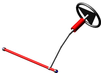
شکل ۳. مدل زیرسیستم مکانیزم فرمان در نرم افزار آدامز
