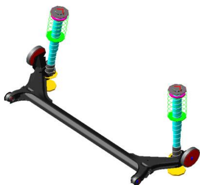
شکل ۲. مدل سیستم تعلیق عقب در نرم افزار آدامز
