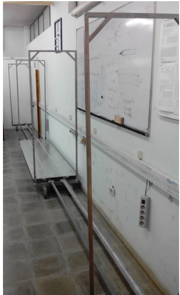
شکل ۱۳. نمای کلی از مجموعه مورد آزمایش که دو بخش مربوط به کاهنده شتاب و افزایش شتاب به ترتیب در ابتدا و انتهای تصویر مشخص می‌باشند
