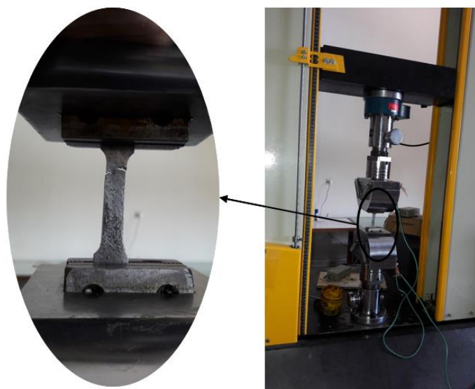
شکل ۵. چیدمان آزمون کشش Fig. 5. Setup of tensile test
