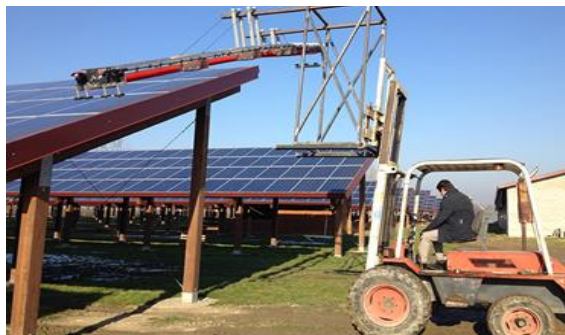
شکل ۲. استفاده از ماشین‌آلات پیچیده برای پاک کردن صفحات، با دسترسی‌های دشوار [۵] Fig. 2. Using complicated machines to clear solar panels with difficult access [5]
