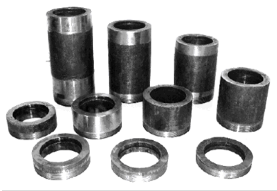
شکل ۲. لوله فولادی جهت ایجاد فاصله استقرار خرج تا ورق
