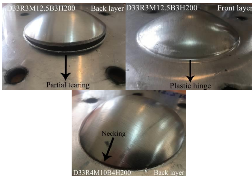
شکل ۸. نمونه‌ای از ساختارهای دولایه آلومینیومی پاره شده و در معرض گلوپی شدن
