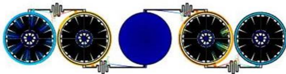
شکل ۹. نمایش حرکت در صفحه حسگر در فرکانس ۱۶/۵ کیلوهرتز
