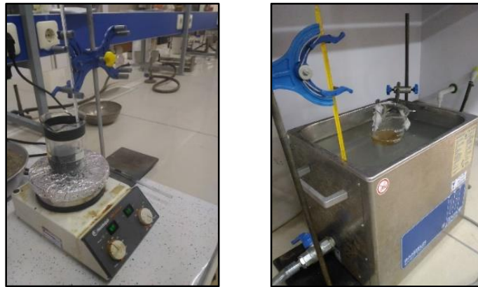
شکل ۱. بشر حاوی پرکننده‌های نانوساختار و رزین درون حمام فراصوت (راست) و همزن مغناطیسی (چپ)
