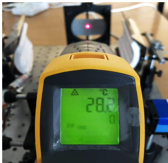
شکل ۵. استفاده از حرارت‌سنج غیرتماسی جهت تعیین سطح دمای نمونه در هر لحظه
