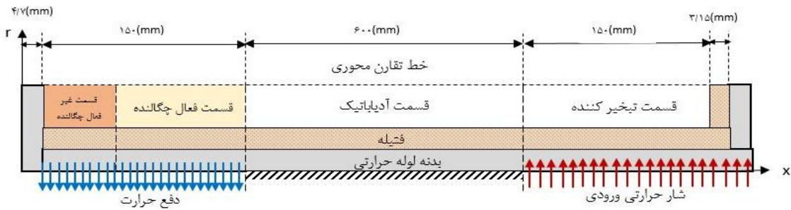
شکل ۱. شمایی از یک لوله حرارتی رسانایی متغیر با مخزن سرد
