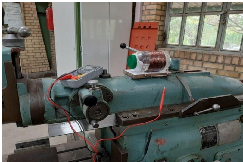
شکل ۸. دستگاه صفحه تراش و سیستم نصب‌شده روی آن
