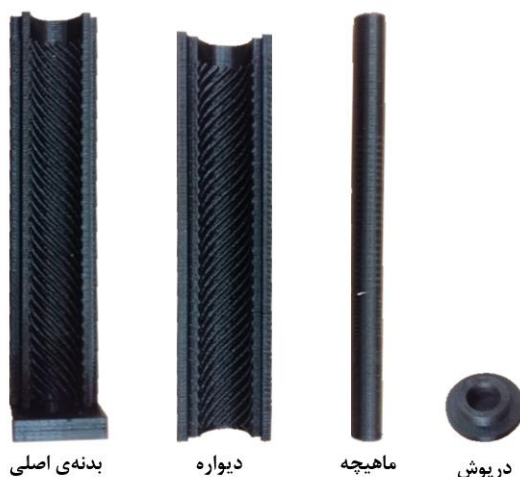
شکل ۴. اجزای تشکیل دهنده قالب محرک استوانه‌ای خطی-پیچشی
