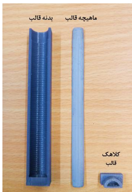
شکل ۶: اجزای تشکیل‌دهنده‌ی قالب محرک خمشی نیم‌استوانه‌ای
