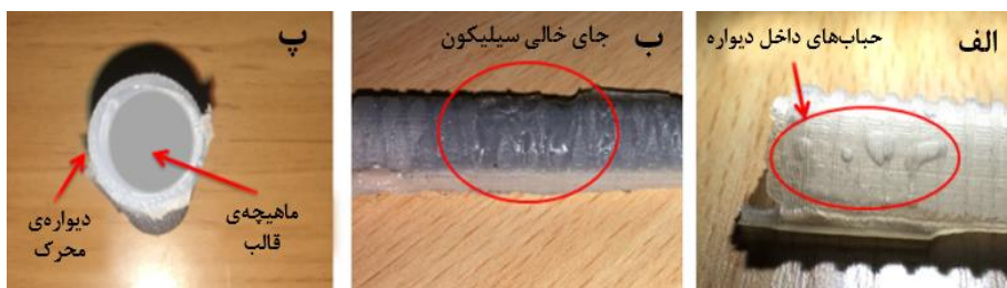
شکل ۵. عیوب قالب‌گیری قطعه سیلیکونی در اثر حباب‌زدایی نامناسب سیلیکون. الف) تشکیل حباب در دیواره‌ی محرک، ب) پر نشدن کامل قالب و ناقص ماندن قطعه قالب‌گیری شده و پ) خروج ماهیچه از مرکز و غیریکنواخت شدن ضخامت دیواره‌ی محرک
