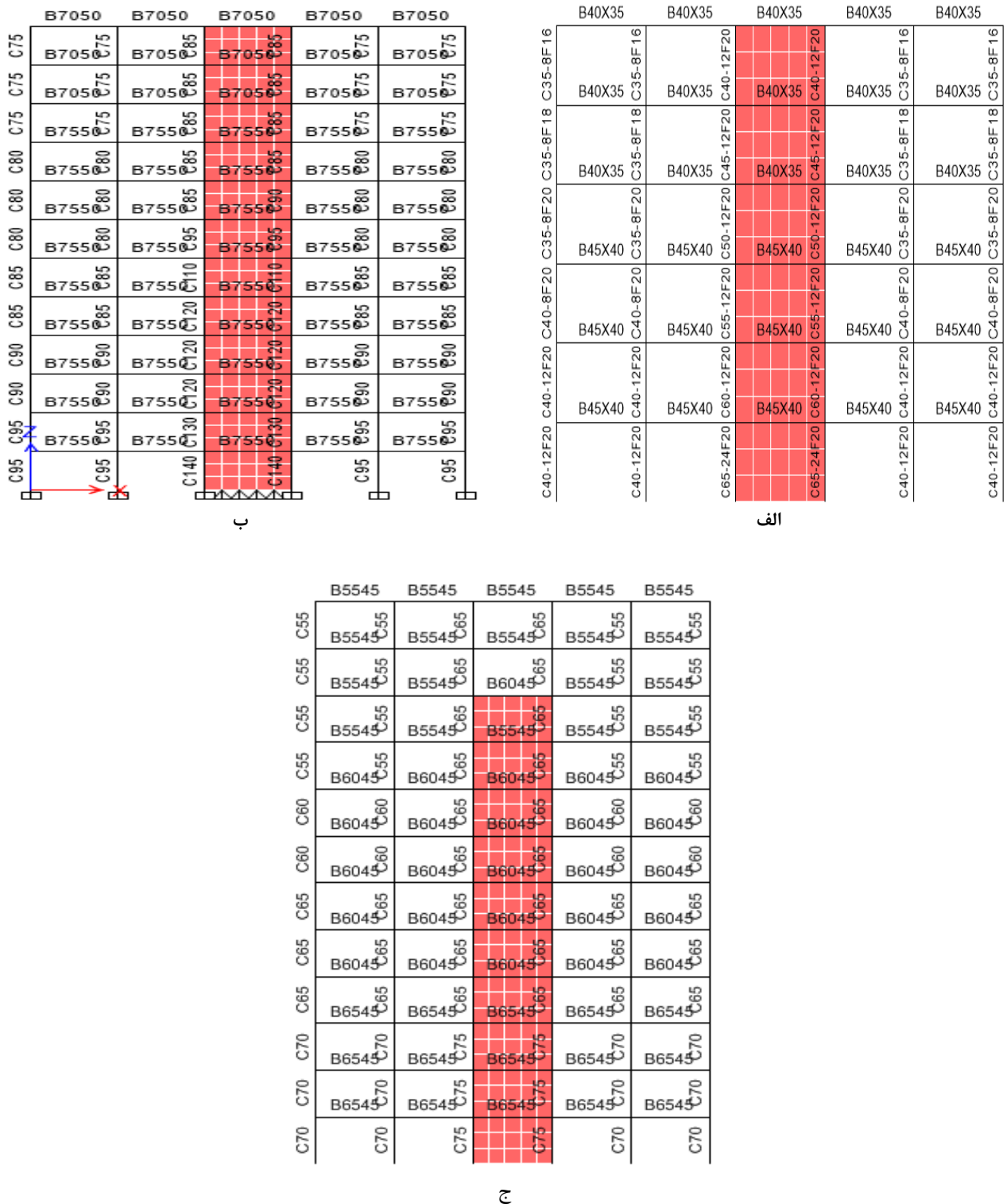
شکل ۴. مقاطع سازه‌ای الف) ۶ طبقه دوم مدل ۱۲ طبقه ب) ۱۲ طبقه اول مدل ۲۴ طبقه ج) مقاطع سازه‌ای ای) ۱۲ طبقه دوم مدل ۲۴ طبقه
