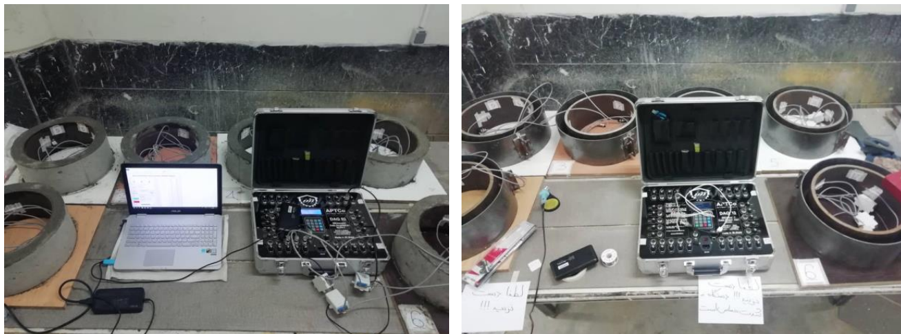
شکل ۳. قالب‌های ساخته شده برای آزمایش جمع شدگی مقید پیش از قالب‌گیری بتن (سمت راست) و در هنگام داده برداری (سمت چپ)
