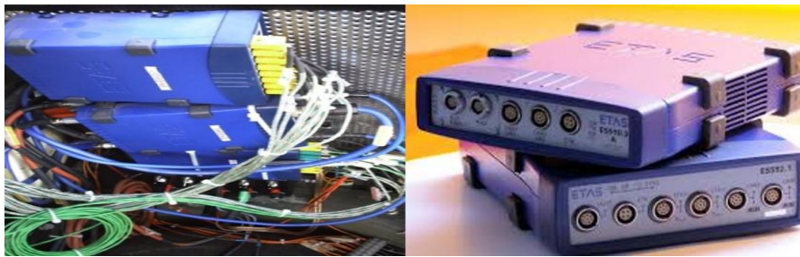
شکل ۲. تصاویری از تجهیزات استخراج اطلاعات از واحد کنترل موتور خودرو [۲۱]
