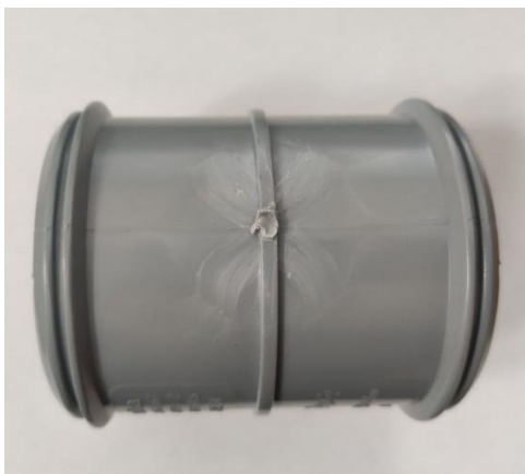
شکل ۱. عیب برش جریان در یک قطعه‌ی بوشن ۶۳ از جنس پی‌وی‌سی
