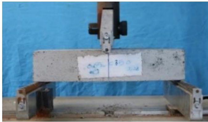
ج- آزمایش خمش سه نقطه‌ای C- Three-point bending test
