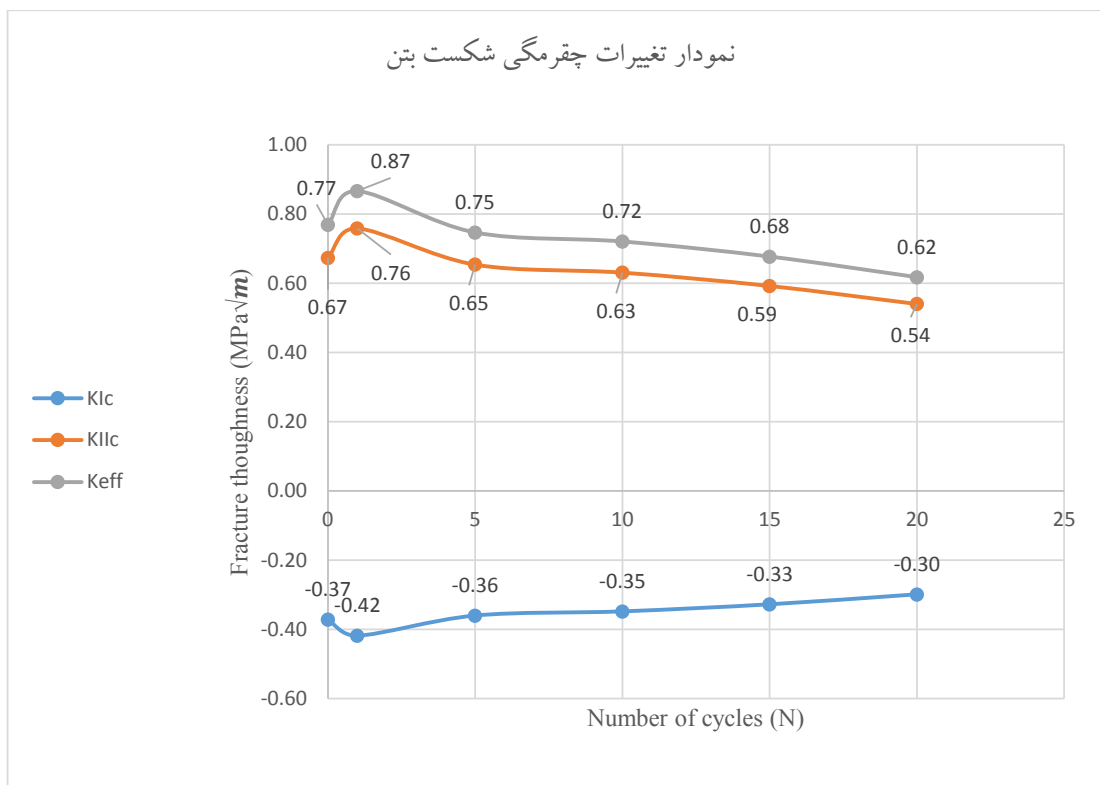
شکل ۱۷. تغییرات چقرمگی شکست بتن با تعداد سیکل‌های گرم شدن-خنک شدن در حالت زاویه انحراف ترک ۴۵ درجه
