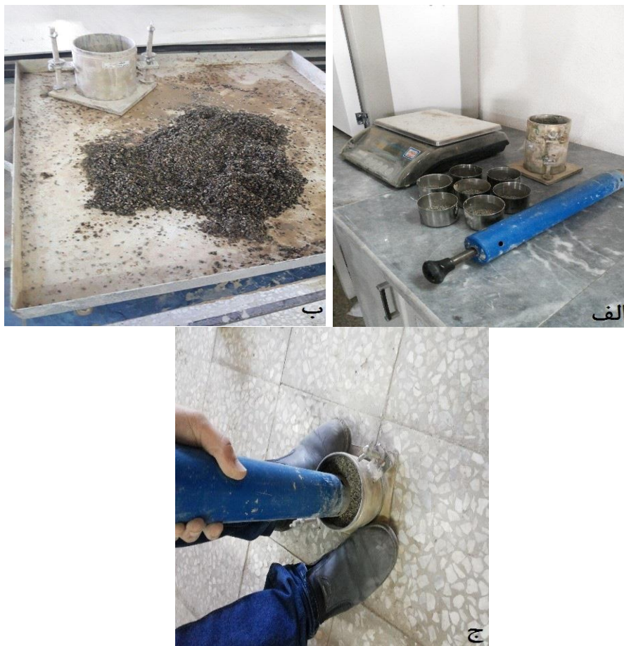
شکل ۴. مراحل انجام آزمایش تراکم - الف) تجهیزات لازم، ب) خاک مورد آزمایش، ج) کوبش خاک با چکش
