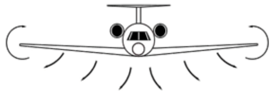
شکل ۱. گردابه‌های نوک بال در فاصله دور از سطح
