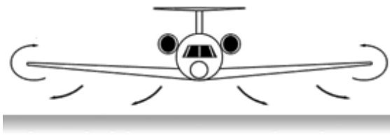
شکل ۲. گردابه‌های نوک بال در فاصله نزدیک سطح
