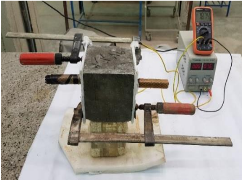
شکل ۲. اندازه‌گیری مقاومت ویژه الکتریکی بتن.
