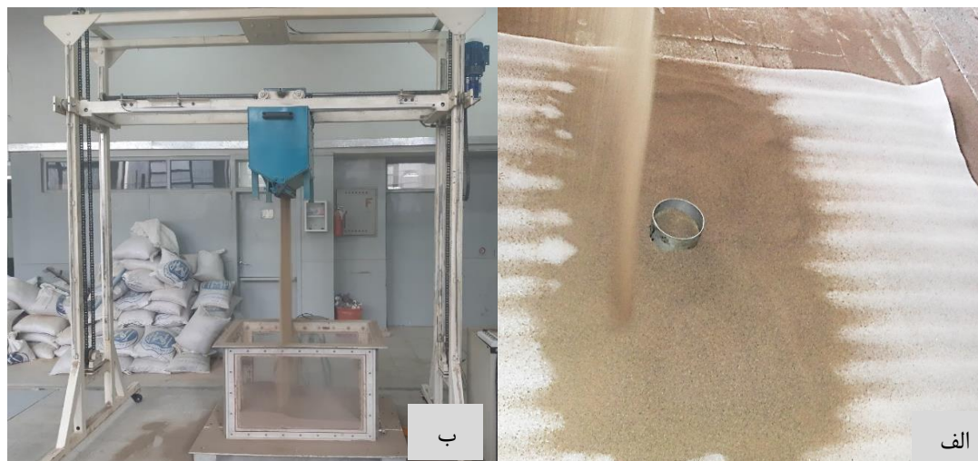
شکل ۲. دستگاه بارش ماسه (الف) اندازه‌گیری دانسیته نسبی (ب) بارش ماسه از دستگاه برای آماده‌سازی نمونه
