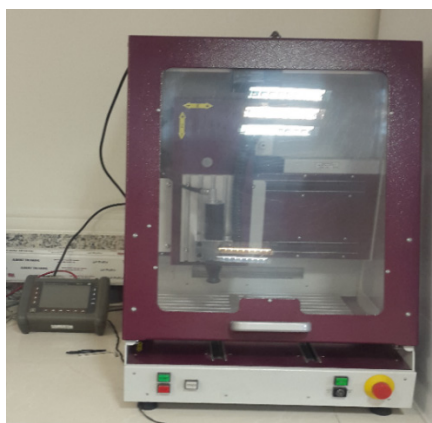
شکل ۱۰ دستگاه اندازه گیری میکروسختی مدل MIC20
