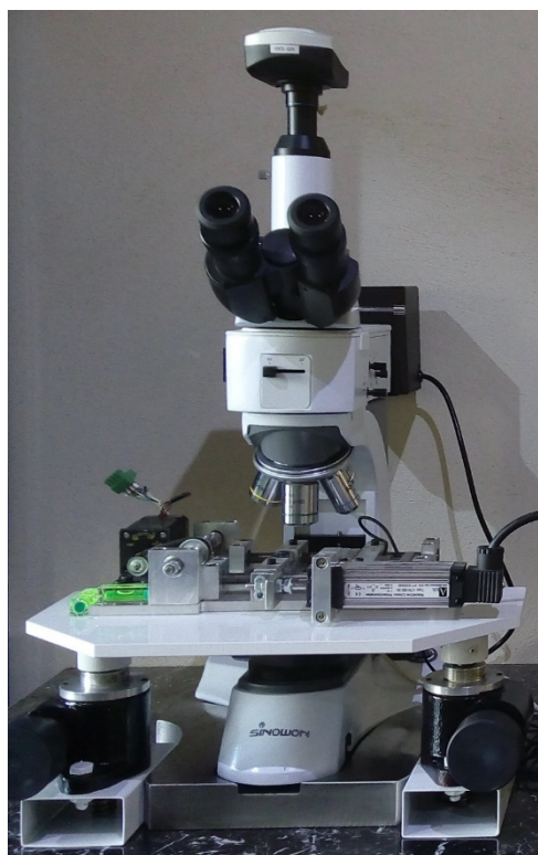
شکل ۲. ست‌آپ آزمایشگاهی (دستگاه تست کشش میکرو قرار گرفته در زیر لنز میکروسکوپ نوری) Fig. 2. Experimental setup (a micro-tensile testing machine placed under an optical microscope)
