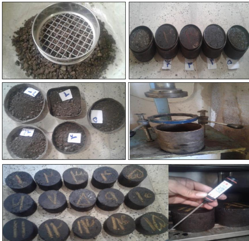
شکل ۲. نحوه تهیه نمونه های مارشال
