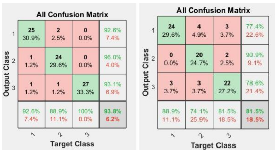
شکل ۹. میزان دقت شبکه در تشخیص صحیح ضخامت چسب با داده‌های شبیه‌سازی (شکل سمت چپ) و با افزودن سه درصد خطای تصادفی به داده‌های شبیه‌سازی (شکل سمت راست)
