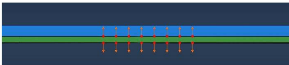
شکل ۴. اعمال جابه‌جایی بر ورق آلومینیومی و تحریک آن
