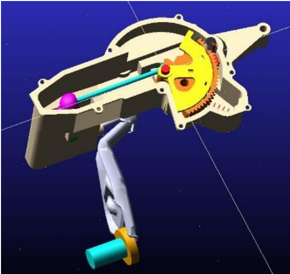
شکل ۵. مدل عملگر کلاچ در نرم افزار آدامز/ویو
