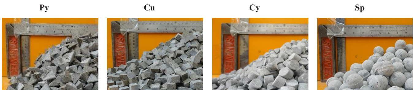
شکل ۱۰. تعیین زاویه اصطکاک داخلی دانه‌های بتنی بر اساس استاندارد ASTM-C1444
