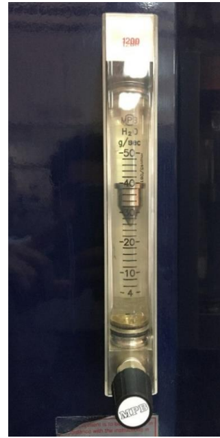
شکل ۶. فلومتر روتاری آب در برج خنک‌کن آزمایشگاهی
