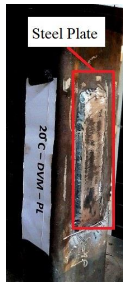
شکل ۱۲. نحوه مقاوم‌سازی نمونه‌ها به وسیله ورق‌های فولادی
