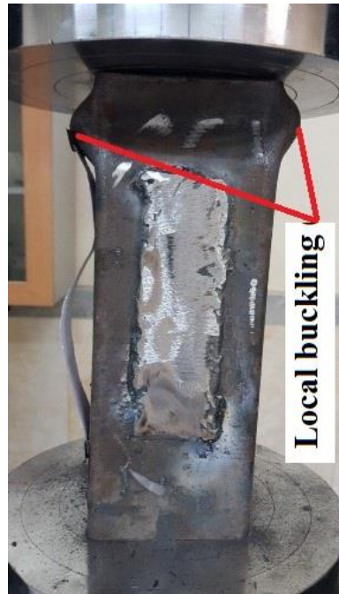
ج) کمانش موضعی متقارن به دور از محل مقاوم‌سازی شده
