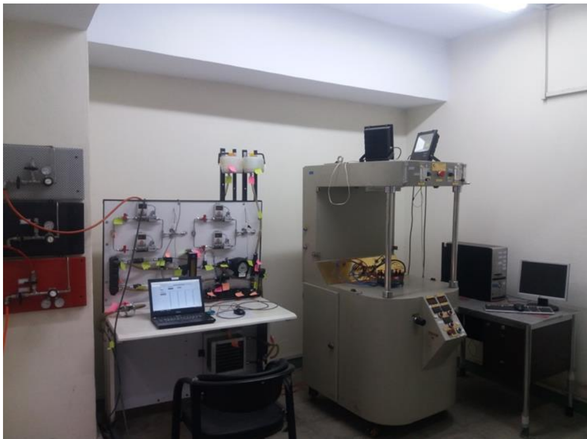
شکل ۱. میز آزمون طراحی و ساخته شده در آزمایشگاه پیل سوختی دانشکده مهندسی مکانیک دانشگاه صنعتی امیرکبیر (سمت چپ تصویر) در کنار میز اولیه آزمون ساخته شده توسط پژوهشگاه فضایی ایران (سمت راست تصویر).
