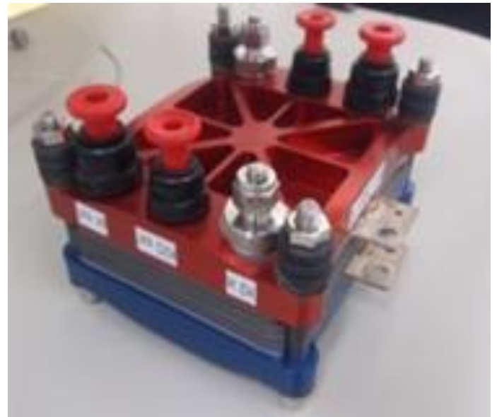
شکل ۲. پیل سوختی غشا پلیمری سه سلولی طراحی و ساخته شده توسط مرکز تحقیقات هیدروژن و انرژی خورشیدی ZSW آلمان
