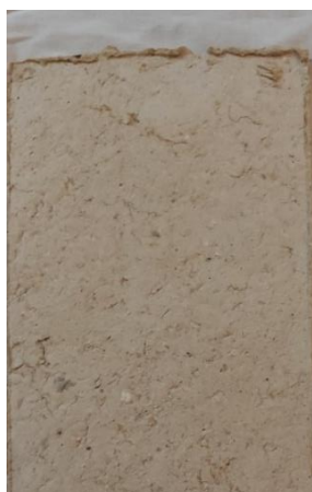
شکل ۲. صفحه مقوایی ساخته شده به روش مکانیکی
