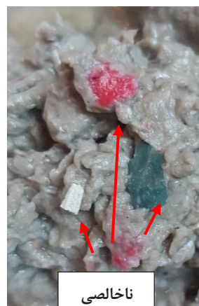
شکل ۱. وجود اجزا متفرقه در مقوا
