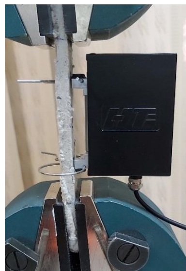
شکل ۶. اتصال نمونه مقوا کارتنی در فک کشش
