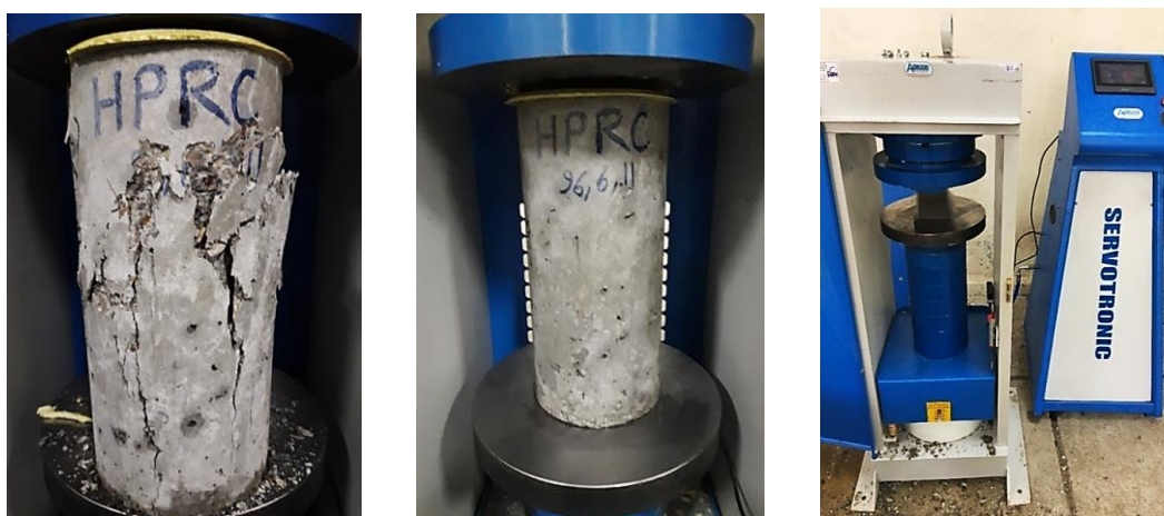
شکل ۸. جک فشاری ۲۰۰ تنی و نمونه‌ها قبل و بعد از انجام آزمایش مقاومت فشاری.
