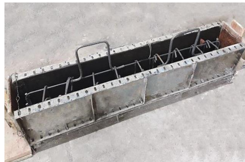
شکل ۴. نحوه بستن شبکه آرماتور و قالب فلزی.
