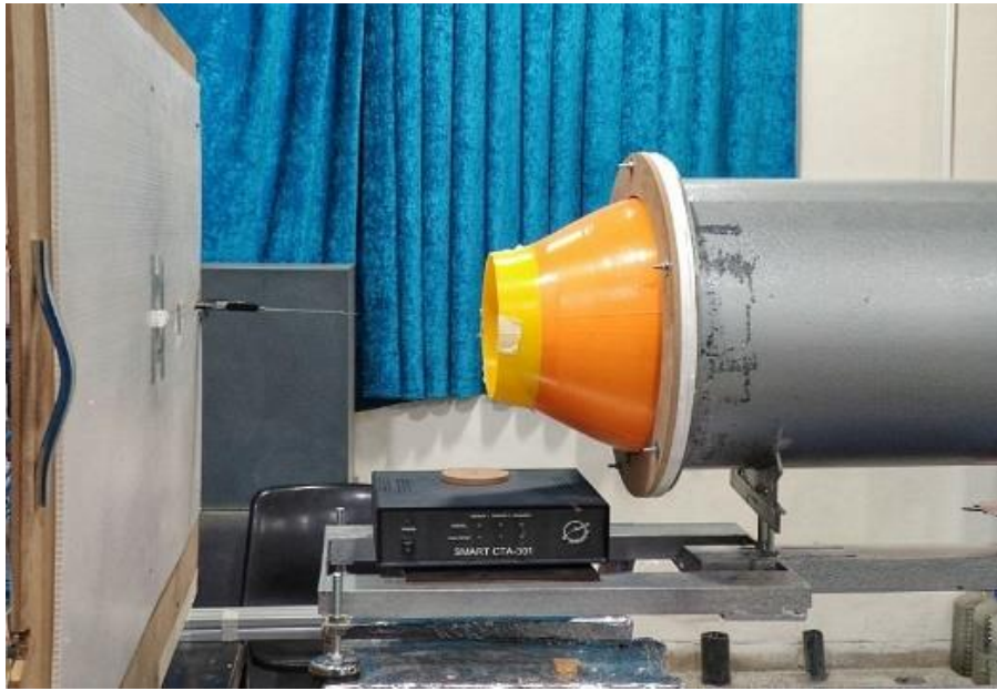
شکل ۵. نمای کناری از چیدمان دمنده، صفحه‌ی آزمایش و مدل
