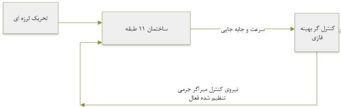
الف) کنترل کننده فازی a) Fuzzy Logic Controller system
