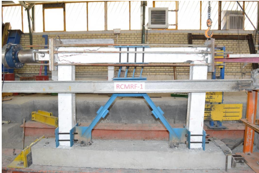
شکل ۹. آسیب‌های قاب و تغییر شکل‌های ماندگار در قاب بعد از اعمال بارگذاری در مدل
