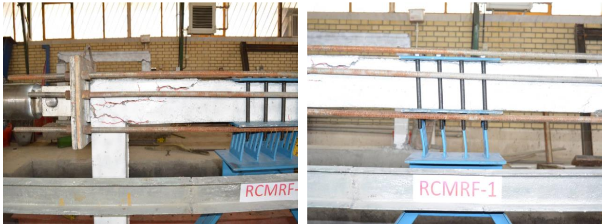
ب) آسیب در محل اتصال تیر به ستون قاب دارای میراگر
