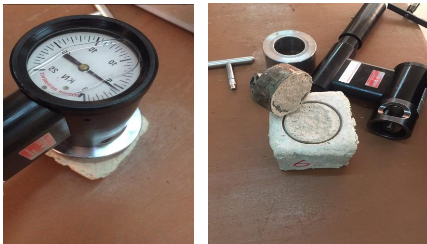
شکل ۲. دستگاه مخصوص Pull-Off و خواندن اعداد روی آن در حین کشش.
