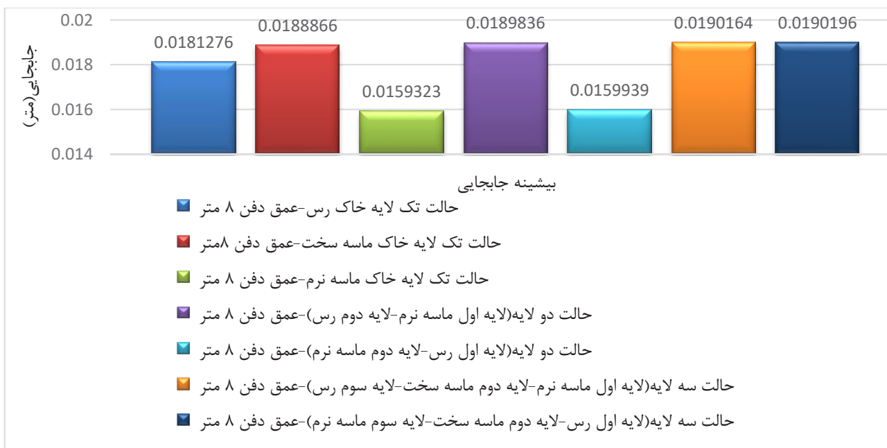
شکل ۱۶. بیشینه جابجایی برای تمامی حالات خاک در عمق دفن ۸ متر
