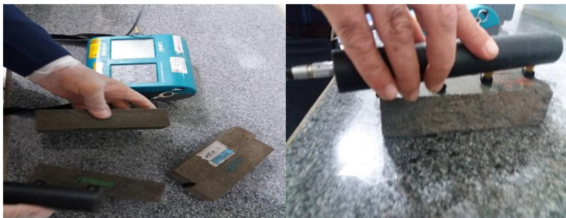
شکل ۱۱. نمایی از نحوه انجام آزمایش مقاومت الکتریکی
