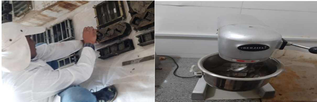
شکل ۲. ساخت و قالب گیری نمونه ها از ملات های سیمان- سرباره ای
