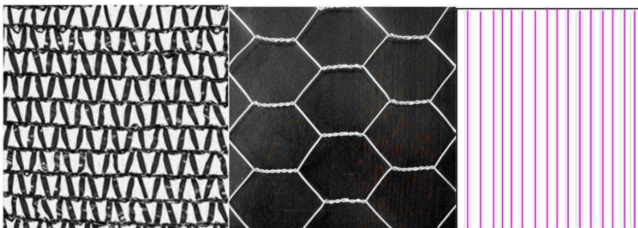
شکل ۳. ساختار توری‌های مورد استفاده در آزمایش. تصویر سمت چپ: توری راشل [۲۴]، تصویر میانی: توری ۶ - ضلعی تصویر سمت راست: توری تارهای تفلونی
