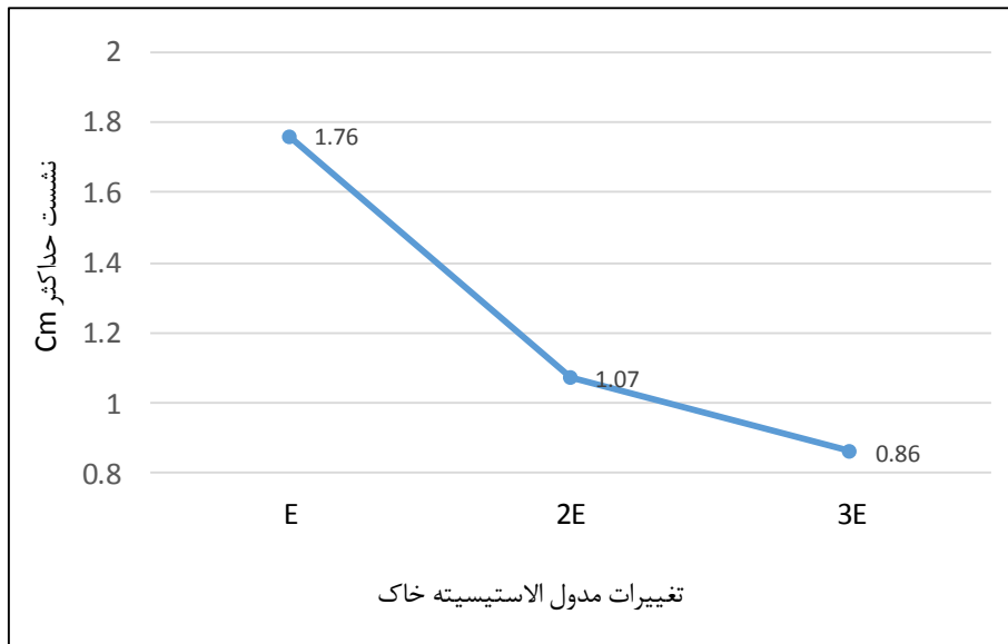
شکل ۱۹. تغییرات جابه‌جایی‌ها با تغییر مدول الاستیسیته خاک
